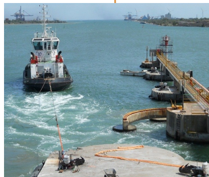
Test de traction sur les nouveaux crocs
